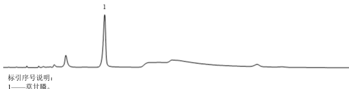
图2 32%苯嘧磺草胺·草甘膦可分散油悬浮剂中草甘膦高效液相色谱图
