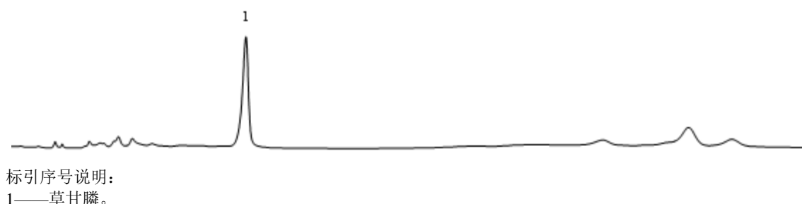
图2 75%苯嘧磺草胺·草甘膦水分散粒剂中草甘膦高效液相色谱图
