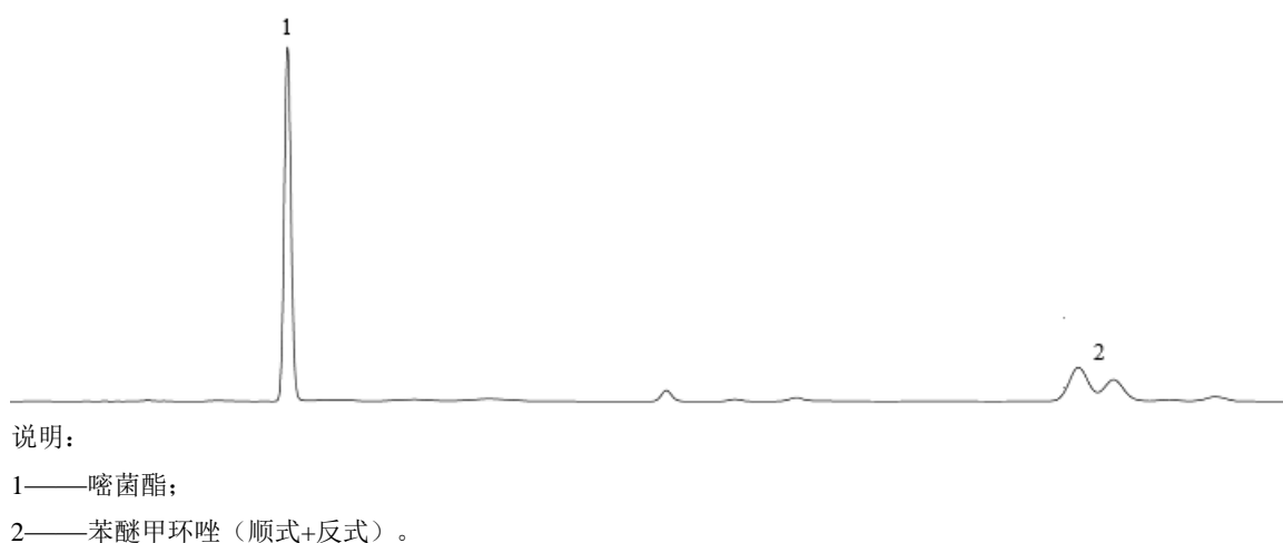
图1 325 g/L 苯醚甲环唑·嘧菌酯悬浮剂高效液相色谱图
